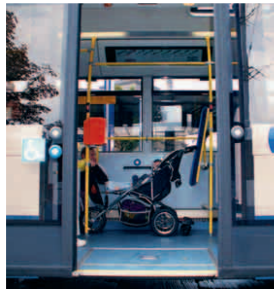
Türe auf: Der breite Einstieg zur Plattform in der Busmitte bietet einen hindernisfreien Zugang für Kinderwagen oder Rollstühle.
