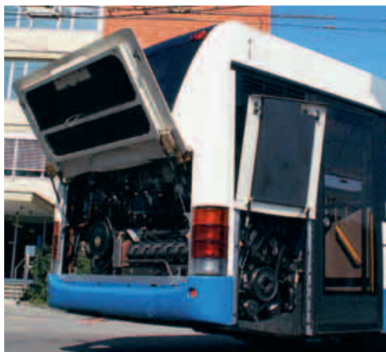
Servicefreundlich: Der quer liegende Motor im Heck und seine Aggregate sind rundum über Klappen gut zugänglich.
