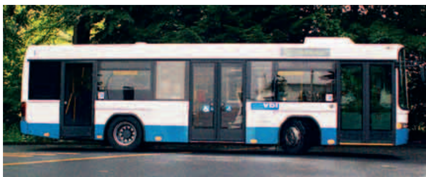
Einladend: Drei Türen garantieren einen hohen Fahrgastfluss.
