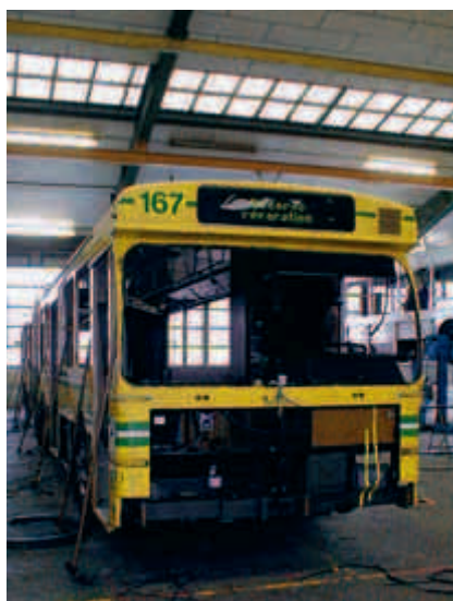
Verdiente Pause: Wagen 167 mit 20-jähriger Lackierung, jedoch ohne Innenausbau und Befensterung in den Werkhallen von HESS in Bellach.
