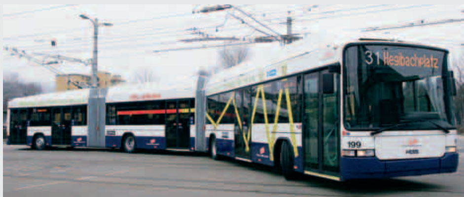
Imposant: Die gelenkte Achse am Heck sorgt dafür, dass auch das hinterste Modul in den Kurven exakt in der Spur des Vorderwagens mitläuft.
