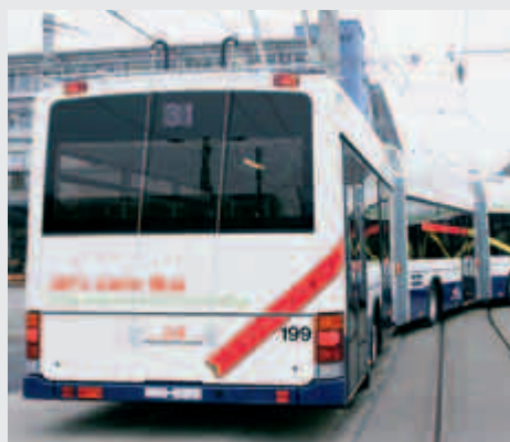
Imposant: Die gelenkte Achse am Heck sorgt dafür, dass auch das hinterste Modul in den Kurven exakt in der Spur des Vorderwagens mitläuft.
