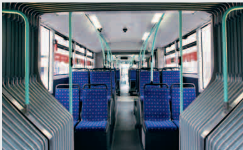
Endlos: Von vorne bis zuhinterst bietet der Doppelgelenk-trolleybus eine Niederflurplattform von rund 24 Meter Länge.
