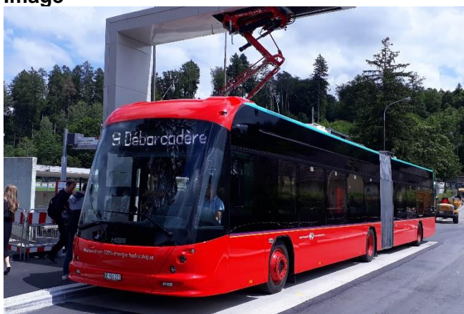
Légende: lighTram ® 19 OPP à la station de recharge de Bienne Source: HESS
